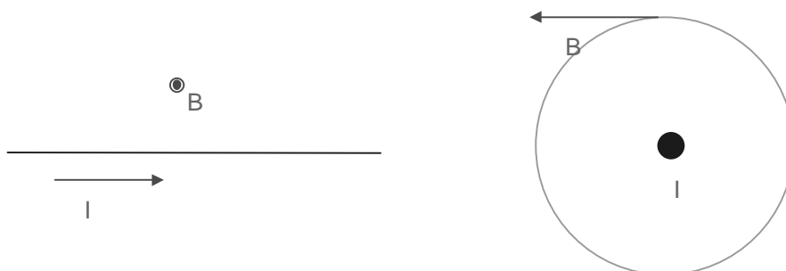
figura 9.1 - Campo devido a uma corrente elétrica em um condutor.
