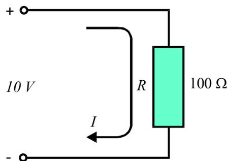
**Fig.9** Potência dissipada em um resistor
