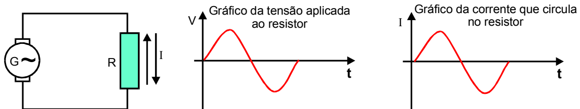
Fig.15 Corrente alternada senoidal através de uma carga alimentada por uma tensão alternada senoidal.
