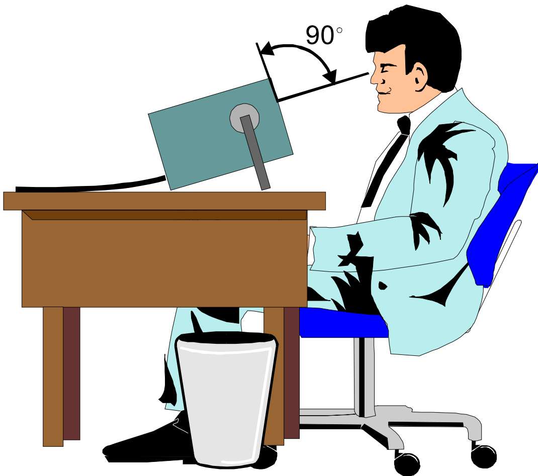
Fig.2 Posição correta do operador para a realização do ajuste do traço na tela.
