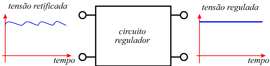
Fig.3 Efeito de um circuito regulador sobre a tensão de saída de uma fonte retificada.
