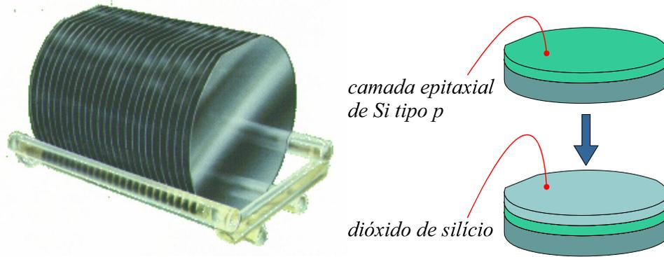
**Fig.5** Bolachas de silício empilhadas em suporte de quartzo. Após tratamento em banho de vapor a uma temperatura de  $1.250^{\circ}\text{C}$ , forma-se uma fina camada de dióxido de silício por sobre a camada epitaxial.
