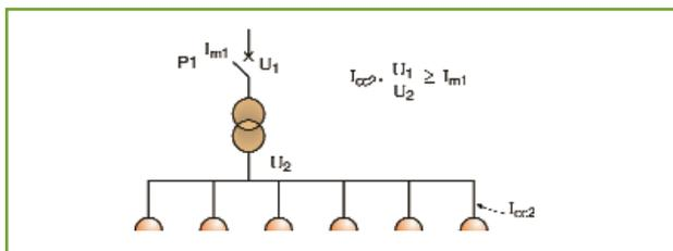
Fig. 3 – A proteção do circuito secundário pode ser garantida pelo dispositivo do circuito primário (P1) se a corrente de curto-circuito mínima  $I_{sc2}$ , referida à tensão do circuito primário, for pelo menos igual à corrente que assegura a atuação do dispositivo P1
