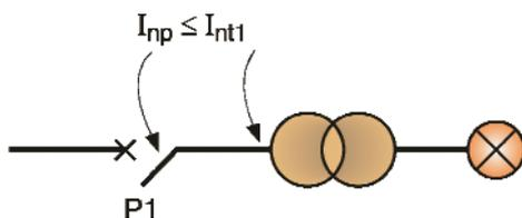
Fig. 1 – A proteção do bloco transformador-lâmpada é garantida pelo dispositivo de proteção P1, no primário do transformador
