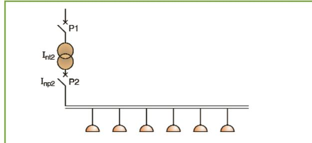
Fig. 2 – A proteção do trilho de alimentação das lâmpadas requer um dispositivo no secundário (P2)
